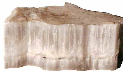
Figura 1.1. El guix natural o algeps és un mineral format per cristalls de la sal sulfat de calci—aigua (1/2) o sulfat de calci dihidratat, \text{CaSO}_4 \cdot 2\text{H}_2\text{O} .
