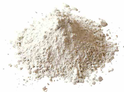
Figura 1.2. L'escaiola o el guix són productes de la cocció de l'algeps. Aquest es deshidrata i el resultat és la sal sulfat de calci—aigua (2/1), 2\text{CaSO}_4 \cdot \text{H}_2\text{O} . La pols àrida d'aquesta sal es pot moldejar si s'hi afegeix aigua; quan s'asseca, cristal·litza una altra vegada en \text{CaSO}_4 \cdot 2\text{H}_2\text{O} .
