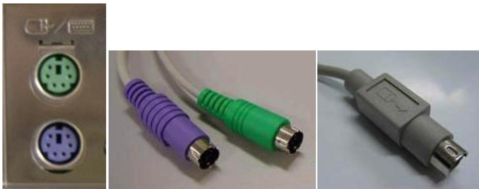
En la imagen de la izquierda vemos los conectores PS/2 de la placa base. A continuación diferentes tipos de conectores de teclado y ratón.
