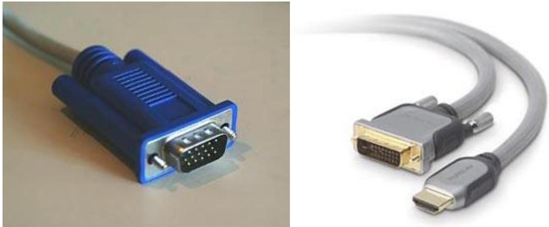
A la izquierda podemos ver un conector VGA y a la derecha un conector HDMI. La clavija más pequeña es la que se conecta al monitor.
