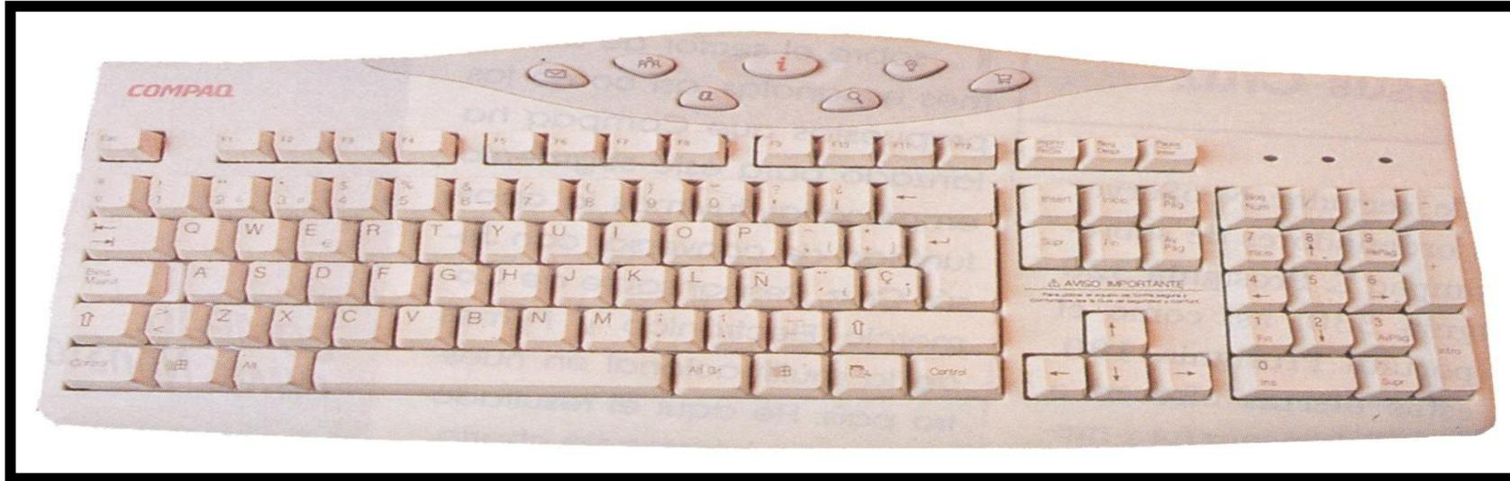
Para visualizar en la pantalla determinados símbolos que no están representados en el teclado, se mantiene pulsada cualquiera de las teclas [Alt] y seguidamente se teclea, única y exclusivamente con el teclado numérico de la derecha, el código ASCII del carácter que se quiera representar. Por ejemplo, al símbolo  $\frac{1}{2}$  le corresponde el código número 171.
