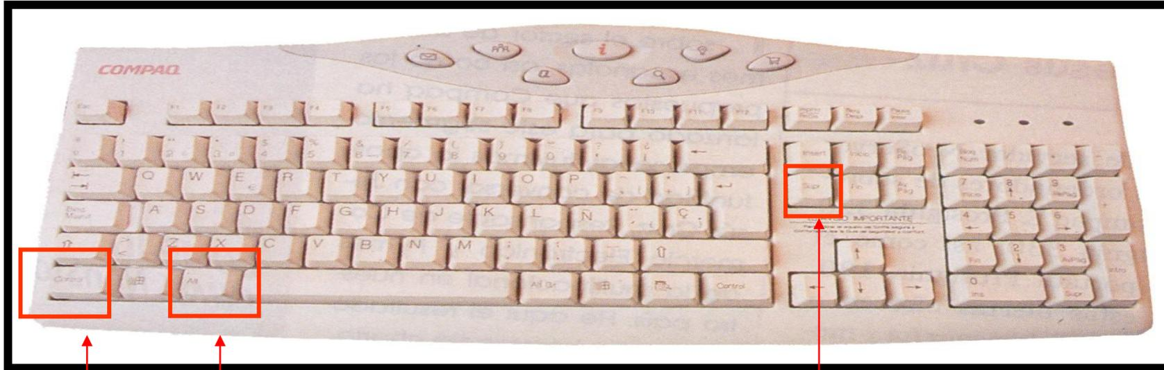
Con el ordenador conectado, **CONTROL+ALT+SUPR** realiza un System-Reset (restauración del sistema). En otras palabras, finaliza la ejecución del programa actual y vuelve a reiniciar el ordenador.
