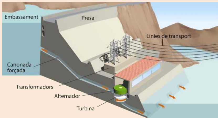
Central hidroelèctrica i esquema simplificat.
