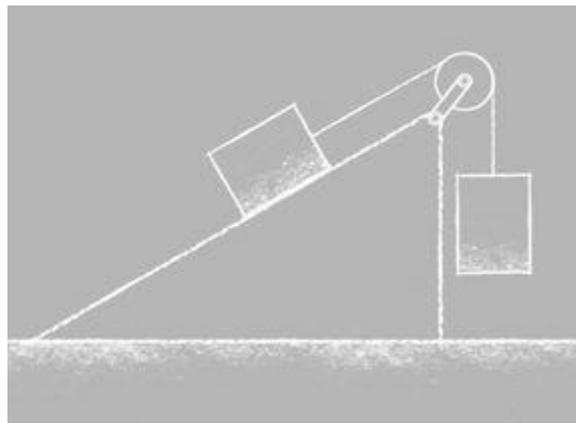
4. Que ocurrirá si tiramos hacia arriba mediante una cuerda de un cuerpo colocado en la mitad de una rampa (sin rozamiento)? Elige la respuesta correcta.
